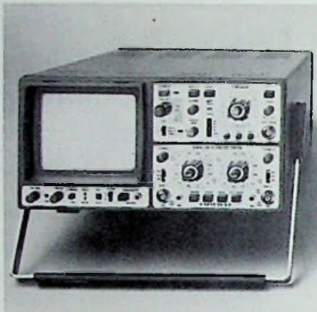
Bild 7: Im Flachformat mit Komponententester: der neue HM 204 (Hameg-Pressbild)
