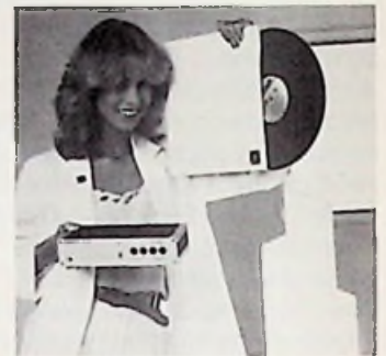
Bild 1: CX-Decoder als Vorsatz für vorhandene Plattenspieler (Telefunken-Pressbild)
