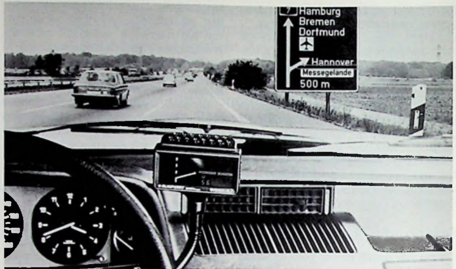
Bild 3: Bordgerät für das Autofahrerleit- und Informationssystem (Blaupunkt-Pressbild)
