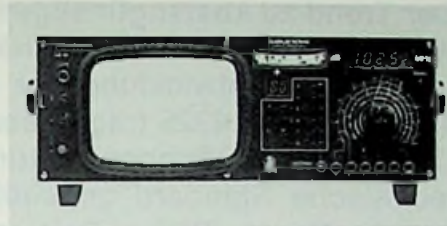
Bild 10: Handlich und hochgenau: Anten- nenmeßempfänger ME 80 für Rundfunk und Fernsehen (Grundlg-Pressbild)
