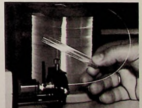
Aus einem 20 cm langen Glasstab werden 1 km Glasfasern gezogen (Foto: AEG-Telefunken)
