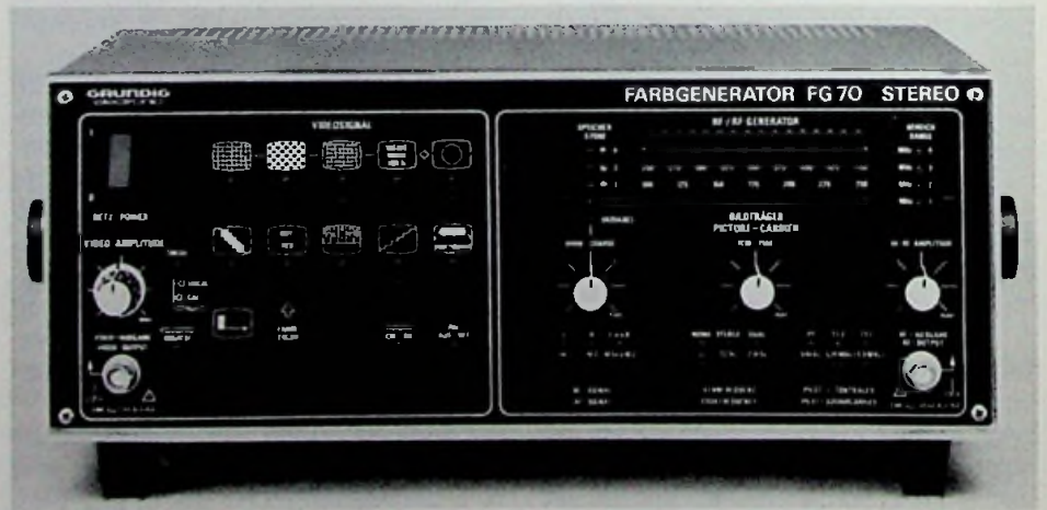
Bild 9: Der Farbgenerator FG 70 beherrscht Stereoton und Kabelkanäle (Grundig-Pressfoto)
